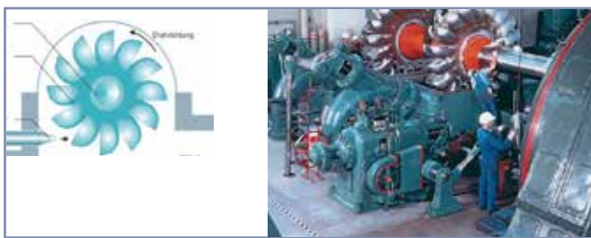
Pelton turbine (Bild: Wasserkraftanlagen/Jürgen Giesecke)
